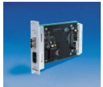
新的千兆扩展器是MICROSENS提供的安装到rack系统中的功能模块系列产品的一部分。除了单/双desktop frame版本，该公司提供容纳12插入件的19" cabinets。多端cabinets允许转换器用于与其他所有同系列插入件的组合。转换器也可集成到现有基于Web的SNMP管理器。
